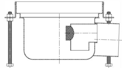
\*THE FLOOR DRAIN IS PLACED AT THE ALREADY SPECIFIED LOCATION. \*THE HEIGHT OF THE FLOOR DRAIN IS ADJUSTED. THE TOP OF THE FLOOR DRAIN SHOULD BE ADJUSTED 0.5-1.00 MM BELOW THE ANTICIPATED FINISH ED FLOOR LEVEL.
