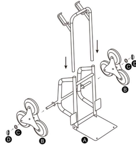
Setze den oberen Rahmen der Sackkarre mit dem Sackkarren-Gestell (A) zusammen. Stecke im nächsten Schritt die Stufenräder (B) durch die seitlichen Holme des Gestells und befestige die Räder jeweils mit einer Unterlegscheibe (C) sowie einer Achskappe (D).
